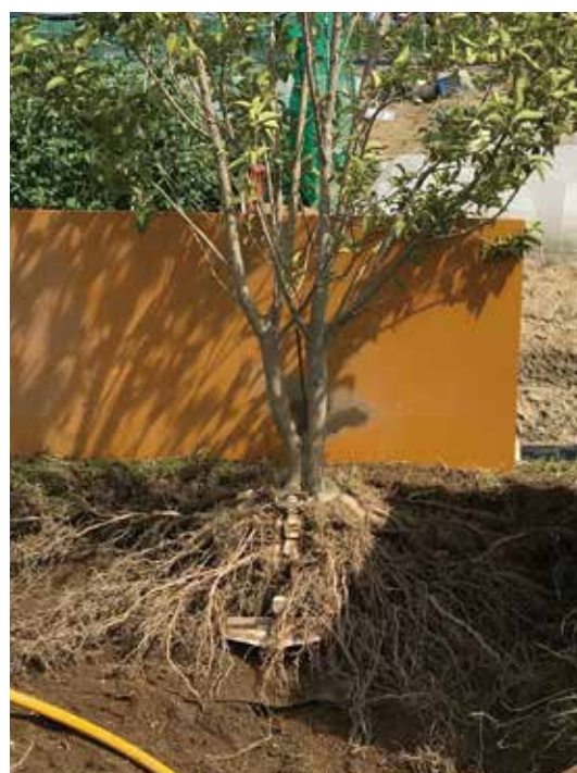
経年で掘り起こした根元。 地下支柱の根に与える影響が少ないことがわかる。
