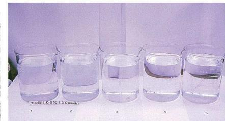
【写真-6】排出液 (エコ炭100%、時間降雨量100mm)
