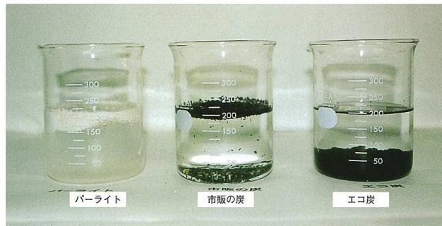
【写真-2】エコ炭の沈降効果
