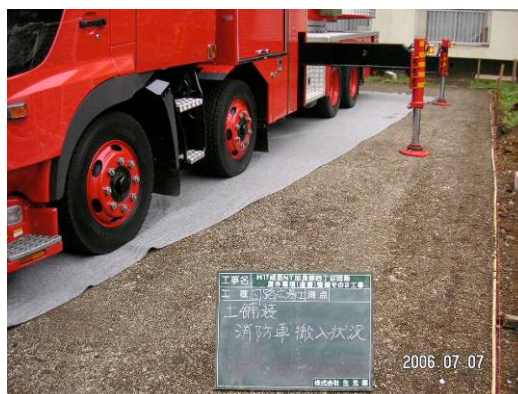
図 1 緊急自動車による基盤土壌のアウトリガー耐圧実験
